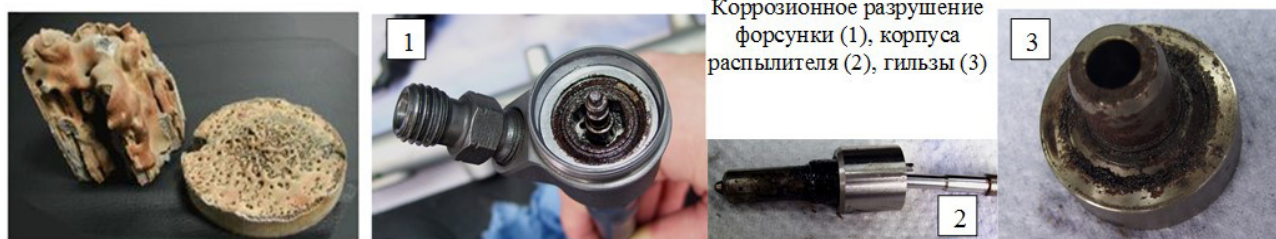
Рисунок 3 – Состояние блоков-носителей при нештатных режимах работы ТКС
